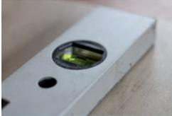
Eine Wasserwaage mit ca. 30 cm Länge passt in jede Werkzeugkiste und ist deshalb immer griffbereit. Ist sie länger musst du sie schon wieder extra verstauen, bei einer kürzeren leidet die Messgenauigkeit.
