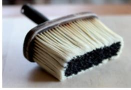
Mit der Quaste lassen sich alte Tapeten hervorragend einweichen. Einfach nass machen und die Tapete Bahn für Bahn bestreichen.
