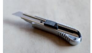
Ist die Klinge beim Cuttermesser stumpf kann sie mit einer Zange gekürzt werden. Einfach an der Perforierung abbrechen.
